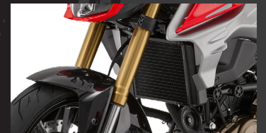
Suspensión delantera telescópica invertida
