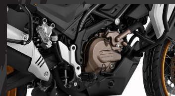
motor 2 cilindros V-Twin de 645 cc
