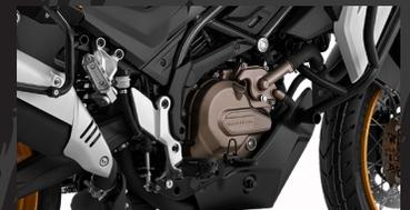
motor 2 cilindros V-Twin de 645 cc
